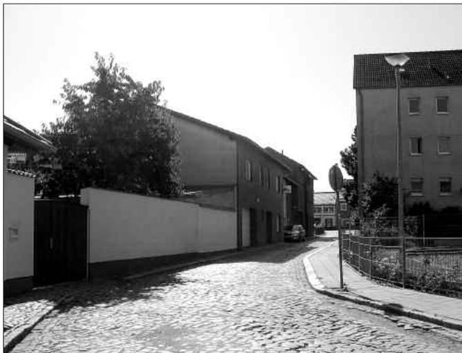
Die Straße „Am Schutzgraben“ wird in einer Breite von 3,50 Meter mit dem vorhandenen Granitgroßsteinpflaster ausgebaut. Auch hier entsteht beiderseits ein Fußweg, wobei der Ausbau einer Seite mit den vorhandenen Feldsteinen erfolgt, wogegen für den gegenüber liegenden Weg Granitplatten verwandt werden. Die in Richtung Brücke Turnhalle stehenden Garagen sollen einer unbefestigten Parkfläche mit Bäumen Platz machen.
