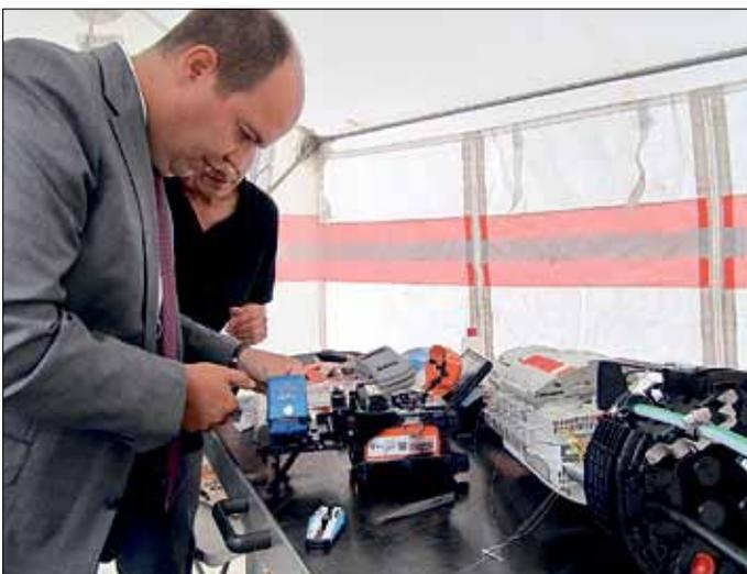
Hierbei werden die Glasfasern (Lichtwellenleiter) mit einem speziellen Lichtbogenspleißgerät gespleißt, wobei Verlegekabel an ihren Enden verbunden werden. Das Spleißgerät justiert die lichtleitenden Kerne der beiden Enden der zu spleißenden Glasfasern punktgenau aufeinander. Anschließend werden die Fasern mit einem Lichtbogen miteinander verschmolzen.
