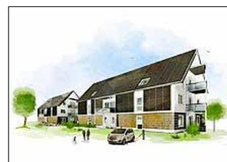
Große Photovoltaik-Anlagen auf den Dächern und an den Fassaden und Infrarotheizungen stehen im Mittelpunkt des Energiekonzeptes der energieautarken, enttechnisierten Mehrfamilienhäuser in Lübben.
